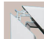
Assemblage des ouvrants et dormants par collage et équerre (coupe d'onglet) ou par vissage et étanchéité (coupe droite).
